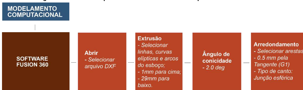
Figura 145 - Fluxo dos processos do modelamento computacional no Fusion 360
