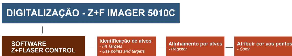
Figura 77 - Etapas de pós-processamento dos dados obtidos com a digitalização tridimensional
