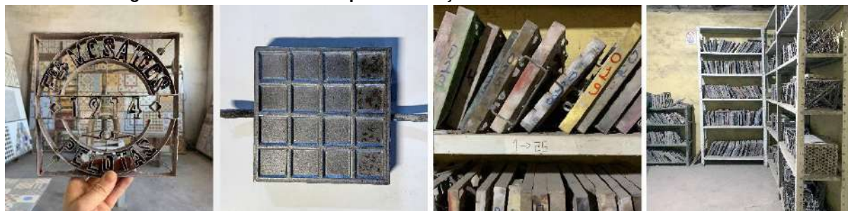
Figura 104 - Moldes e Placas para fabricação dos ladrilhos hidráulicos
