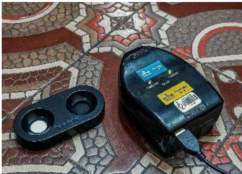
Figura 125 – Uso do colorímetro nos ladrilhos do Paço
