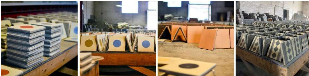
Figura 112 - Etapa de secagem das peças fabricadas
