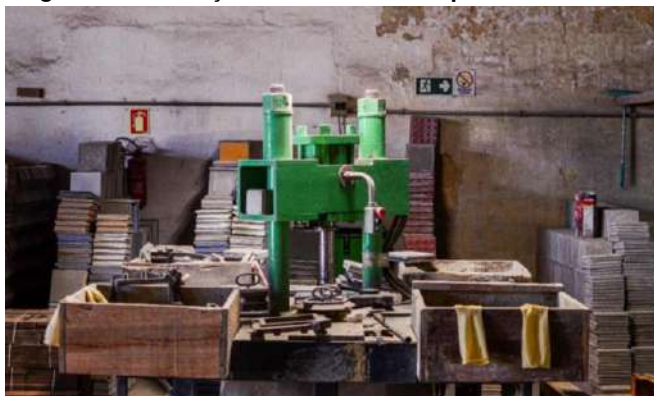
Figura 102 - Estação de trabalho com prensa hidráulica
