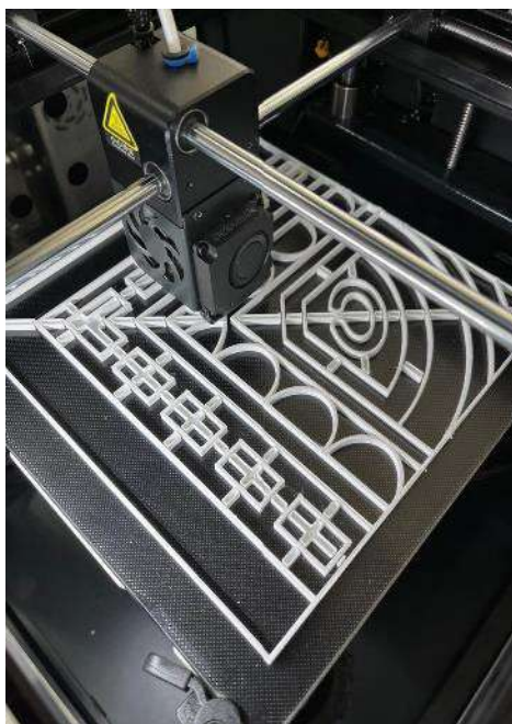
Figura 152 – Molde em processo de impressão
