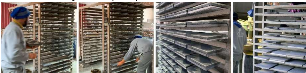
Figura 110 - Etapa de repouso dos ladrilhos recém-fabricados
