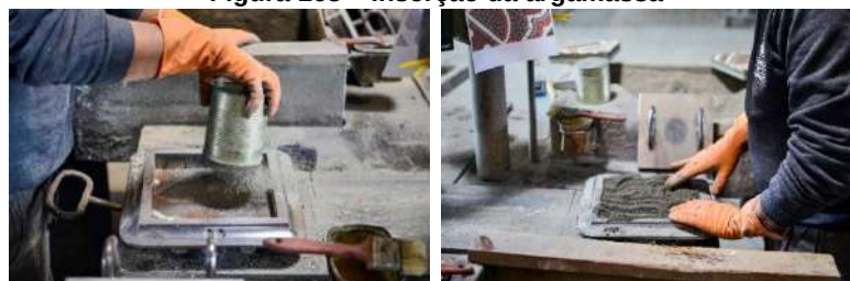
Figura 163 – Inserção da argamassa
