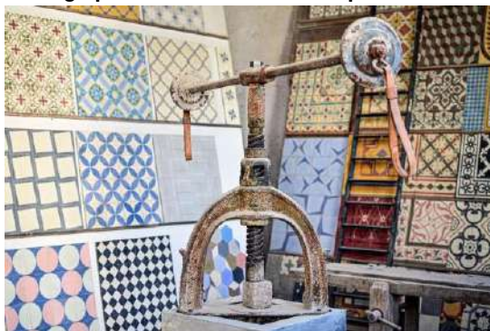
Figura 103 - Antiga prensa manual utilizada pela Fábrica de Mosaicos
