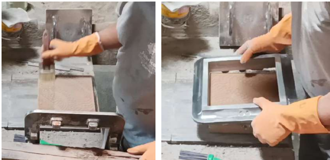
Figura 138 – Aplicação do desmoldante
