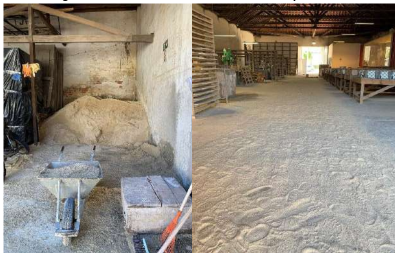
Figura 101 - Areia armazenada e colocada para secar
