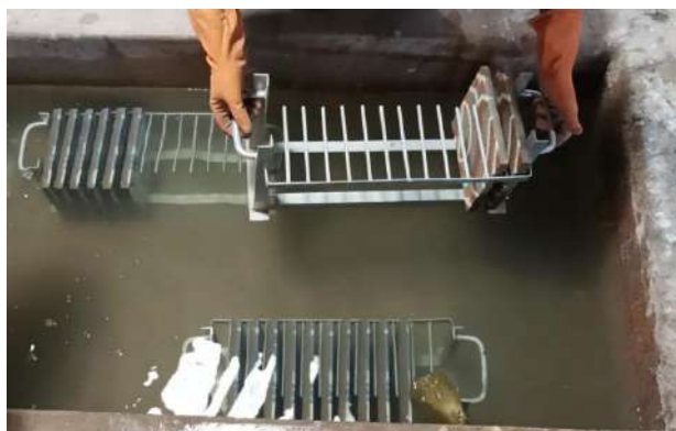
Figura 168 – Processo de cura por imersão em água
