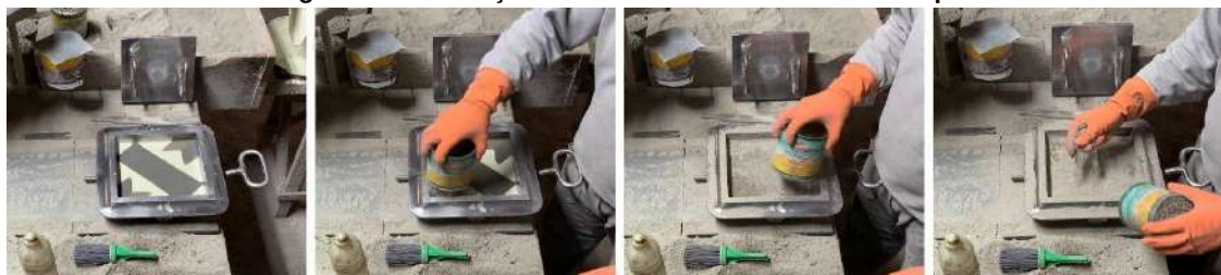
Figura 106 - Inserção do cimento seco na terceira etapa
