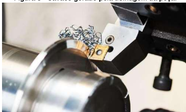
Figura 3 - Cavaco gerado pela usinagem da peça.
