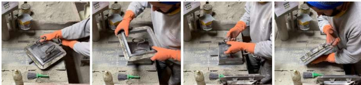
Figura 109 - Desenformagem da peça após a etapa de prensagem
