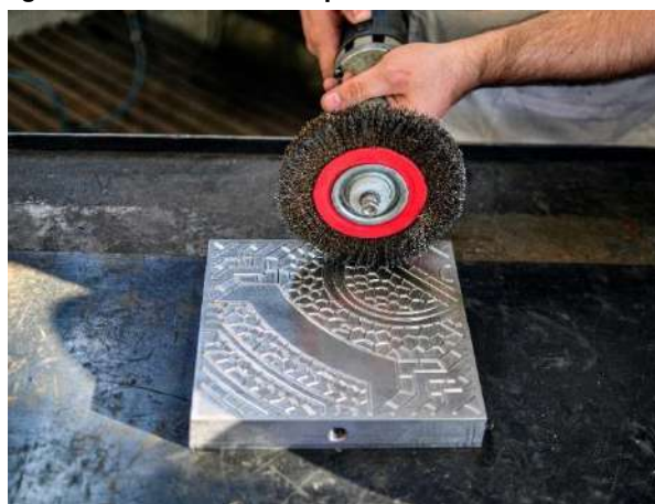
Figura 173 – Processo de polimento com motoesmeril
