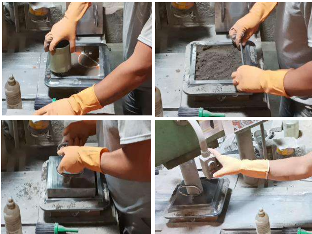
Figura 140 – Despejo das camadas de cimento e areia para preparação da prensagem
