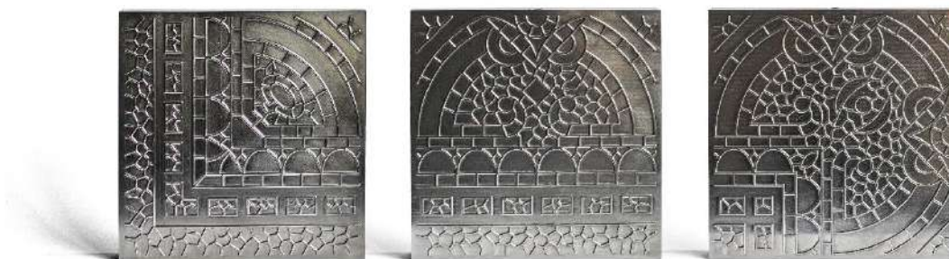
Figura 159 – Matrizes referentes aos cantos e a barra, usinadas em aço P20
